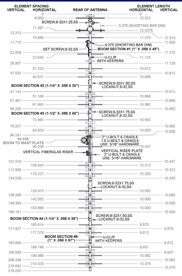
NOTE: DRIVEN ELEMENT BLOCKS SHOWN POSITIONED FOR RIGHT HAND CIRCULARITY
